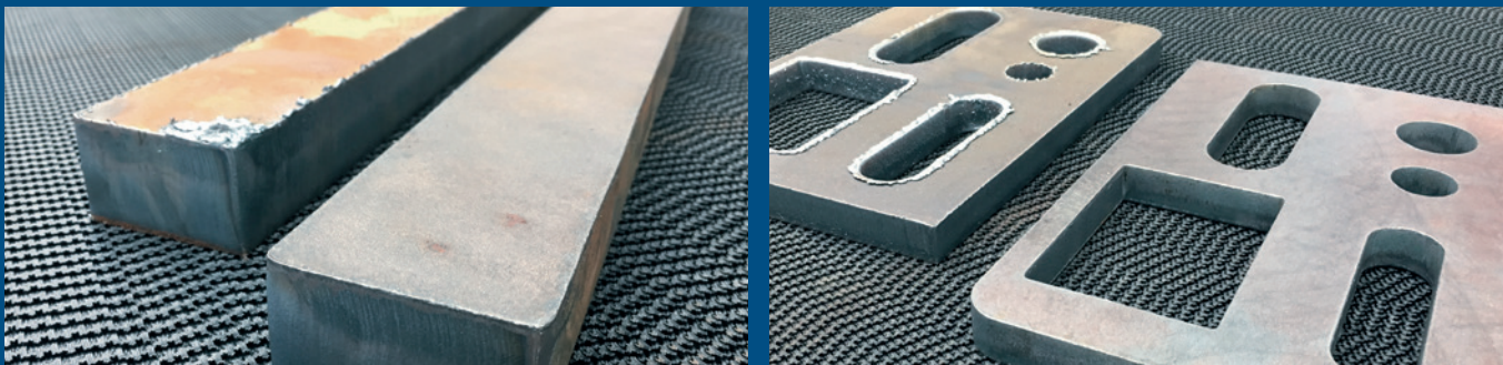
Детали после газокислородной резки до и после обработки на EdgeBreaker® 5000
