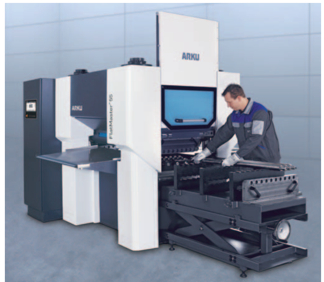
Уникальная разработка ARKU – система быстрой смены вальцов в сочетании с опорным устройством RollerPickup.
